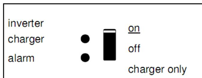
Vstupní střídavé napětí je připojeno a nabíjení je vypnuto. Dobíječ baterie nemůže dosáhnout koncového napětí baterie (režim masivní ochrany ).
