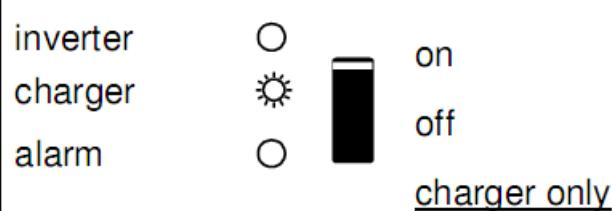
Vstupní střídavé napětí spřipojeno a nabíječka pracuje v udržovacím režimu .
