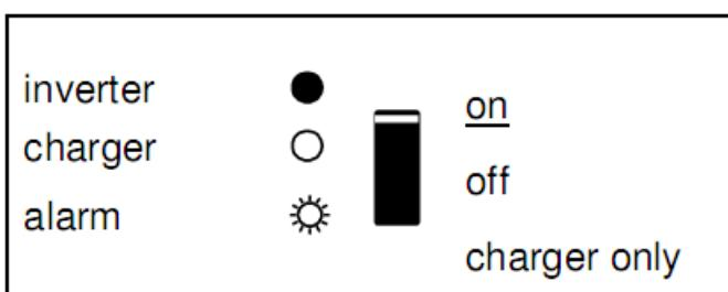
Střídač je zapnutý a dodává proud do zátěže. Pre-alarm: přetížení nebo nízké napětí baterie nebo vysoká teplota střídače
